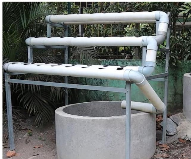
Gambar 1c. sistem hidroponik diatas kolam ikan lele
